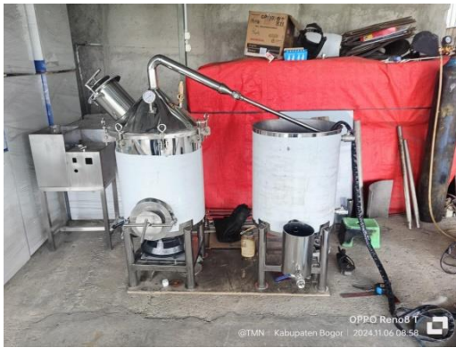
Gambar 3. Mesin Pirolisis (Dok. Pribadi)
