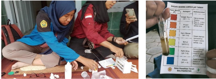
Gambar 4. Uji Unsur Hara Tanah dengan Alat Uji PUTS
